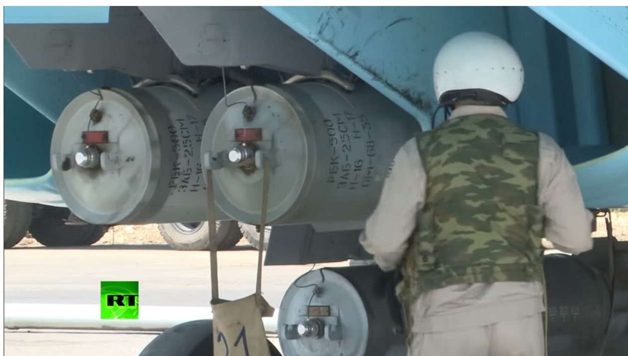
Bombes à sous-munitions incendiaires RBK-500 ZAB 2.5SM sous
