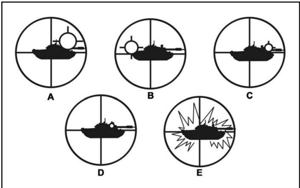
Représentation de ce que doit voir le tireur TOW au fil du vol du missile, même si la cible est mobile: il n'y a dans ce cas aucune correction à faire, si ce n'est maintenir le réticule sur la cible jusqu'à l'impact. Illustration issue du « Field Manual » FM 3-22.34 de l'US Army.
