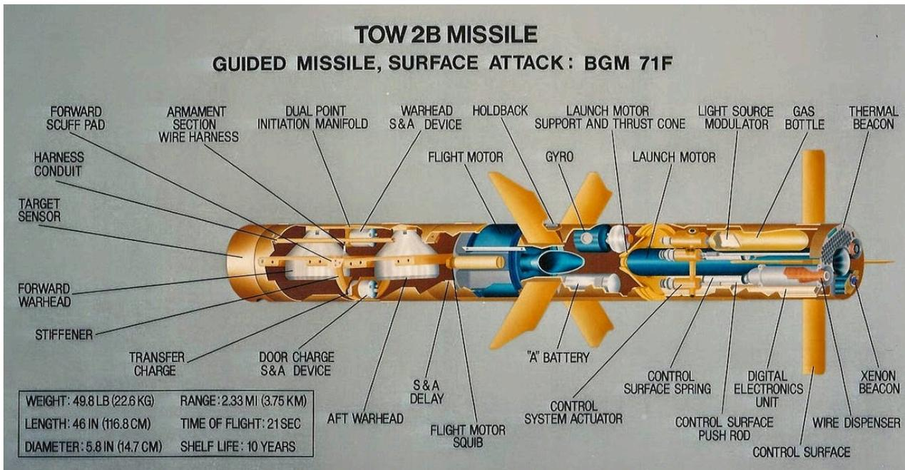
Vue en coupe d'un missile TOW du modèle BGM 71F. Noter à l'arrière: 1) le dérouleur de fil « wire dispenser » (un de chaque côté) et 2) les deux balises, thermique et optique, « thermal beacon » et « xenon beacon », qui renseignent l'appareil de guidage sur la position du missile et les corrections de trajectoire à appliquer.
