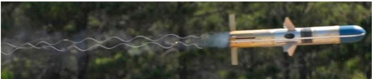
Le missile TOW vient d'être tiré. Le moteur fusée est à la fin de ses 0,05 sec de fonctionnement. Le moteur de croisière, dont on distingue une des deux tuyères sur le flanc, au milieu de l'engin, va prendre le relai, sans émettre de fumée. L'empennage arrière est déployé. L'empennage central est en train de se déployer. Les fils électriques reliant le missile au poste de tir sont bien
