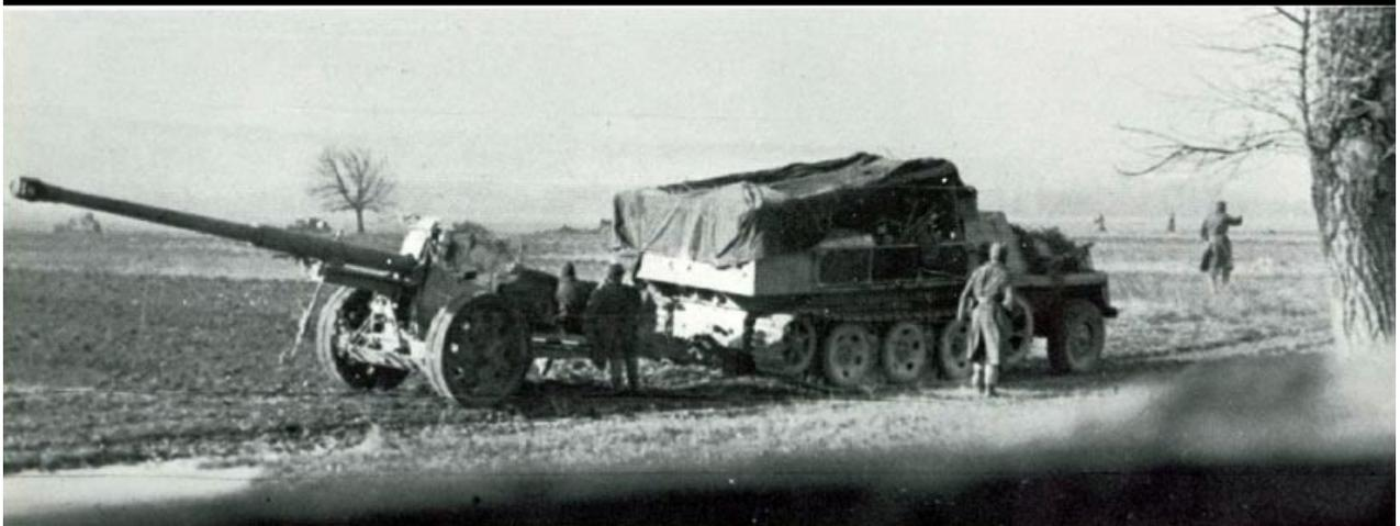
Le canon antichar allemand Panzerabwehrkanone 43 de 8.8cm, apparu en 1943. Son obus perforant de 7,3 kg, lancé à 1100 m/s, porte à 4000m et vient à bout des chars les plus coriaces du moment. Mais la pièce pèse 4,4t et manque cruellement de mobilité.
