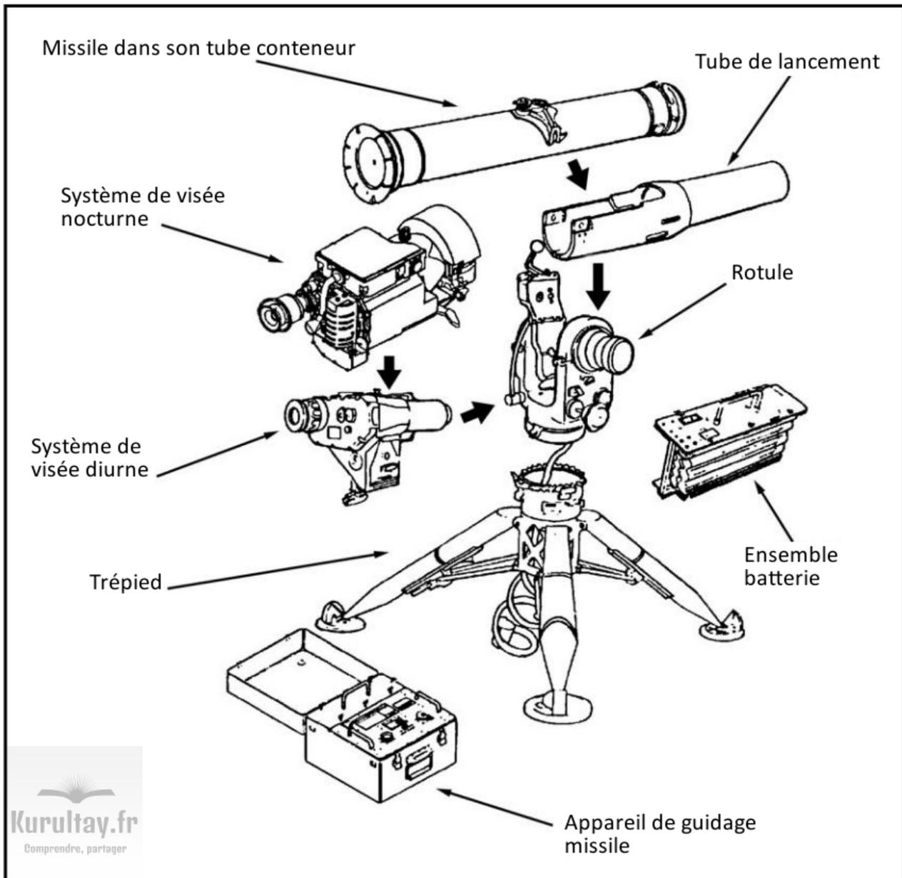
Les composants du poste de tir TOW, à assembler sur place avant usage. Illustration issue du « Field Manual » FM 3-22.34 de l'US Army. Traduction: auteur.
